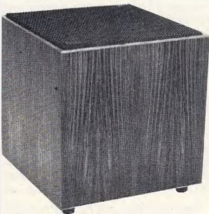
Fig 1. Som alla Sonab-högtalare och Stig Carlsson-skapelser är OD-11 tänkt att samverka med rummet genom utstrålning utåt/uppåt. Den här lilla högtalaren har en inre volym om blott 10 liter.
